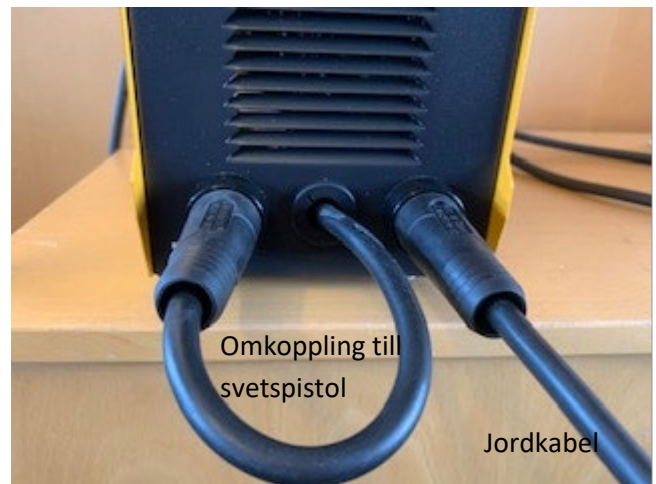
MIG-svetsning med solid tråd och skyddsgas
