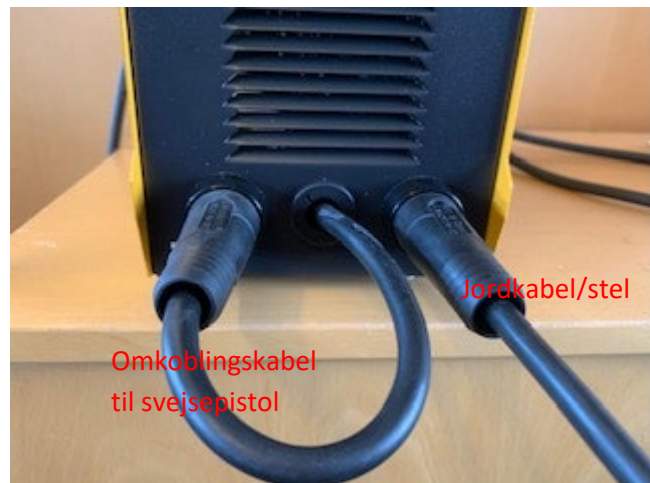
MIG-svejsning med massiv tråd og gas
